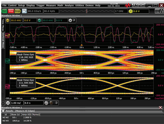
图 10. FEXT 受扰波形之前和之后的视图。顶部的图用绿色表示受扰波形，用橘色表示干扰源、用红色表示去除串扰的波形。中间的图为具有 FEXT 眼形显示的受扰波形眼图。底部的图是去除串扰后的受扰波形眼图。
